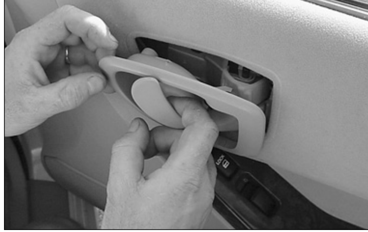
17. And remove the door handle.
