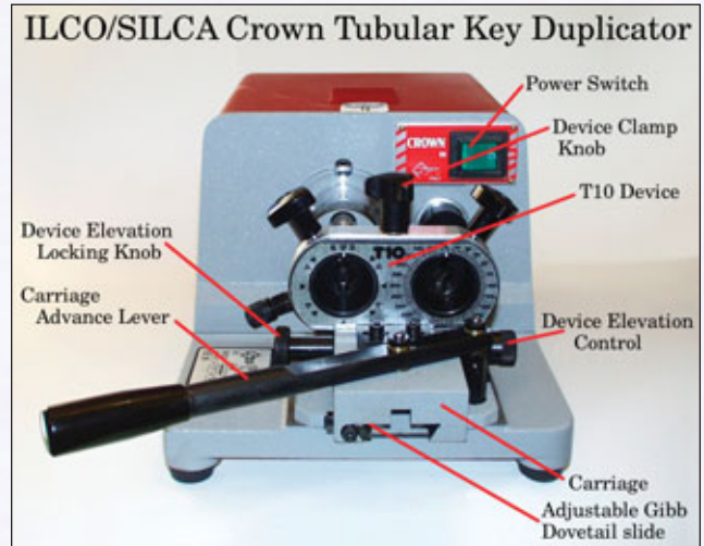
6. The ILCO/Silca Crown tubular key duplicator.
